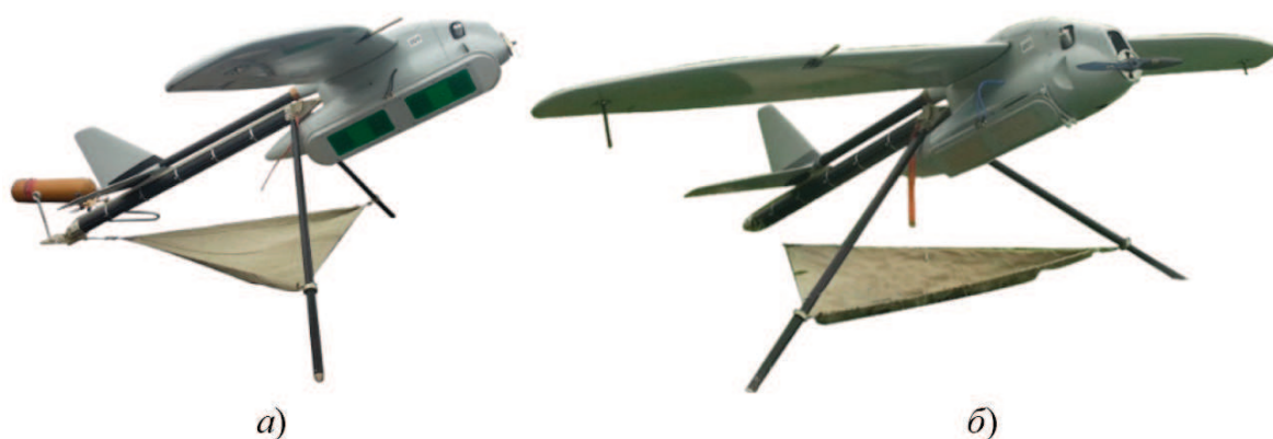
Рисунок П.2 БЛА «Мерлин-21Б» с РСА L- (а) и С- (б) диапазонов длин волн
