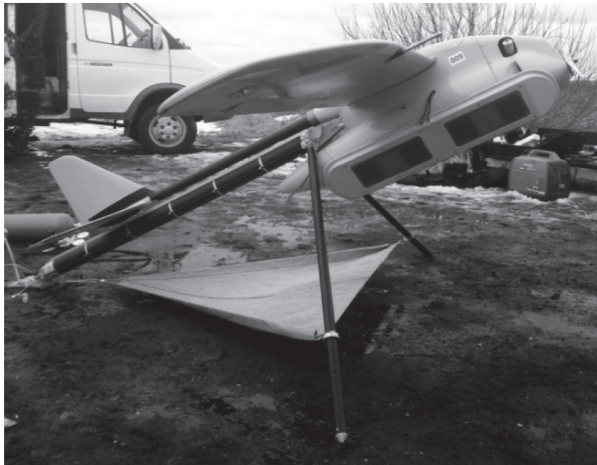
► Рисунок 3.23 БЛА «Мерлин-21Б» с установленной РЛС L-диапазона
