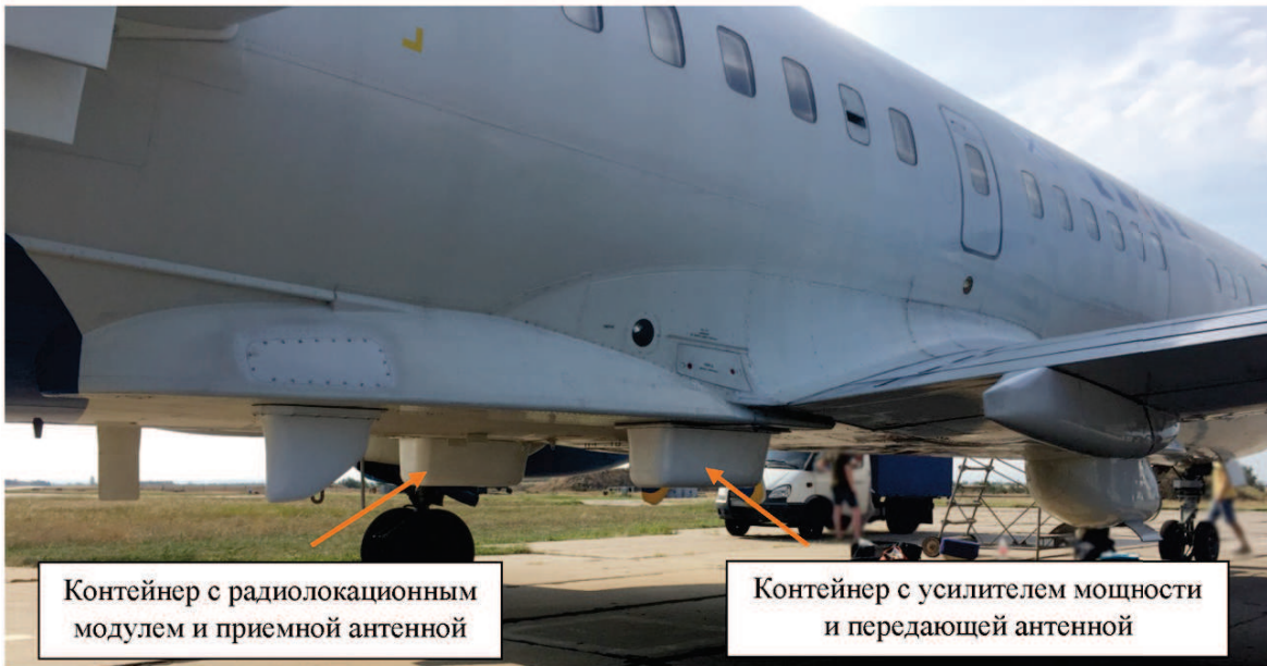
Размещение аппаратуры программно-определяемой РСА на внешних подвесках самолета ИЛ-114лл (АО «НПП «Радар ммс»)
